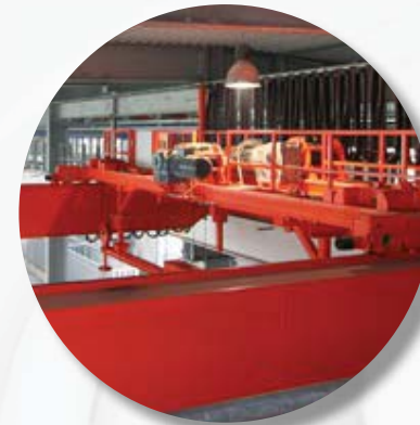
1. Die Krankatte in der Verzinkungsanlage empfängt und sendet Daten über den DATAEAGLE Slave.
